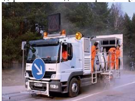
Рисунок 3 – Самохідна маркувальна машина Hofmann H36-2000P на базі вантажного автомобіля Figure 3 – Hofmann H36-2000P self-propelled marking machine based on a truck
